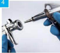
Seque a pistola pulverizando ar comprimido
